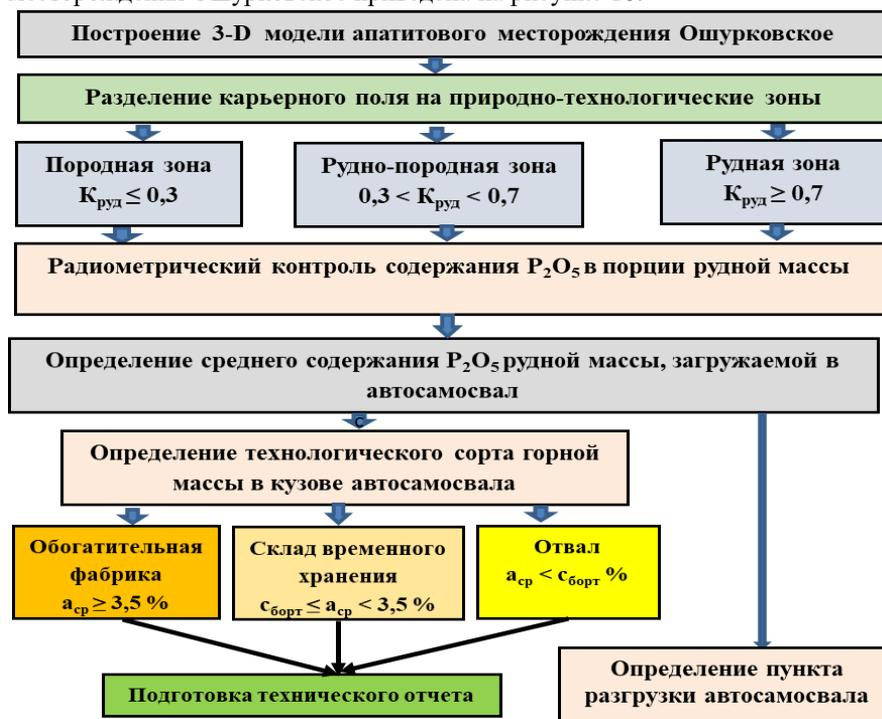
**Рисунок 10.** Схема формирования потоков минерального сырья с заданными качественными характеристиками при разработке месторождения Ошурковское
